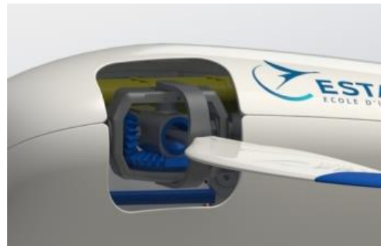
Détail de l'articulation avant avec le système de roues dentées différentiel.
